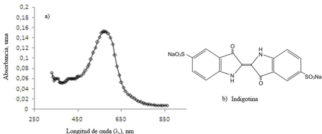
**Figura 1.** a) Espectro de absorción del colorante indigotina b) Estructura química.
