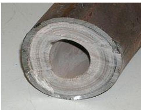
**Figura 1.** Depósito calcáreo en una tubería de agua potable. (Fuente: Wikipedia).
