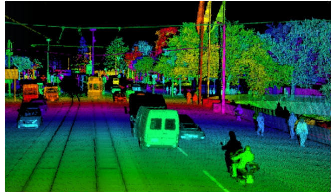
Figura 3. Ejemplo de la imagen generada por un sensor LIDAR
