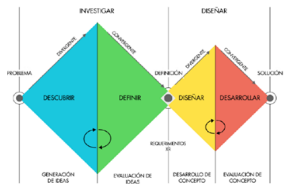
Figura 1. Esquema de doble diamante utilizado en este estudio basado en el esquema propuesto el British Design Council y Stickdorn, 2012
