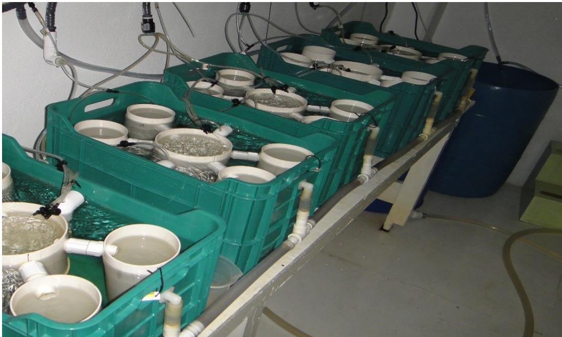
Figura 1. Unidades experimentales integradas por una caja plástica de 35 L de capacidad y cuatro cilindros de PVC 4" con falso fondo de malla plástica para alojar a las semillas. Los cilindros estuvieron acoplados a un tubo central de PVC 8" que tenía dos aerosifones que permitieron la operación de los cilindros con flujo ascendente y recirculante de agua y alimento.
