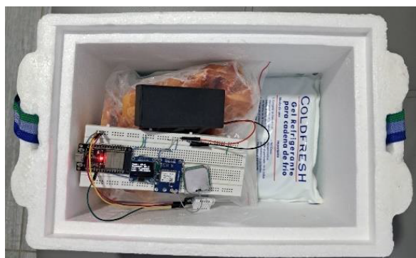
Figura 2. Contenedor de transporte usado para el Sistema IoT de la cadena de frío en el transporte terrestre de alimentos.
